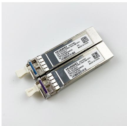
Huawei SFP-10G-BXU1 10GBase, émetteur-récepteur optique BIDI, SFP+, 10G, module monomode (TX1270nm/RX1330nm, 10 km, LC)
