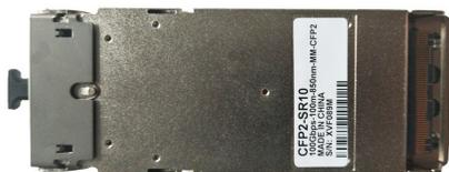
Émetteur-récepteur haute vitesse Huawei CFP2-100G-SR10, CFP2, 100G, module multimode (850 nm, 10\*10G, 0,1 km, MPO)
