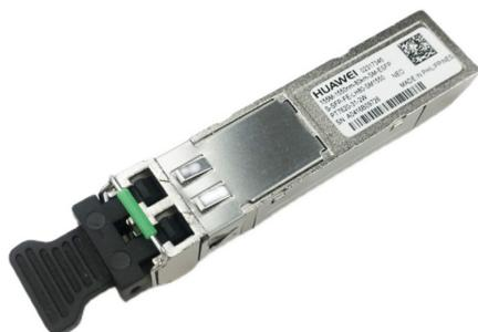
Émetteur-récepteur optique Huawei S-SFP-FE-LH80-SM1550, eSFP, 100M/155M, module monomode (1550nm, 80km, LC)
