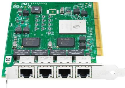
ADAPTATEUR DE SERVEUR GIGABIT □ QUAD-PORTS HPE NC340T PCI-X, 389996-001, 389931-001
