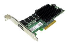
Adaptateur serveur Intel 10 Gigabit XF SR, port unique, LC MMF, 10 GbE, PCIe, 82598EB
