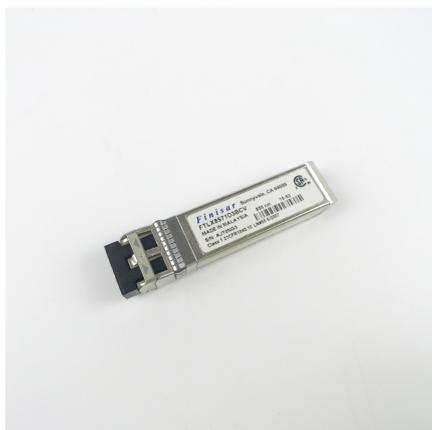
Module émetteur-récepteur à fibre optique SFP+ 10GBASE-SR II-VI Finisar 1G/10G double débit
