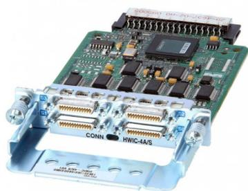
Cisco HWIC-4A/S HWIC série asynchrone/synchrone à 4 ports
