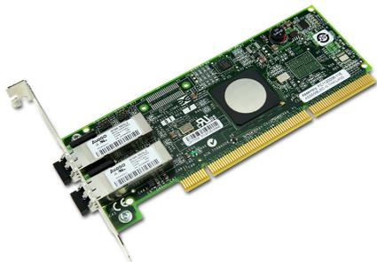
Adaptateur de bus hôte Fibre Channel Emulex LP11002 4GFC PCI 2.0 double port
