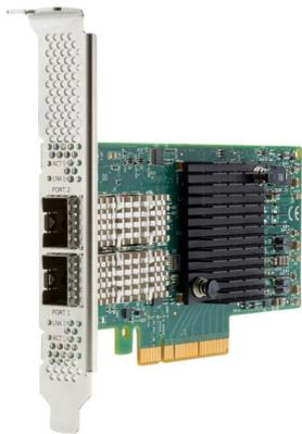
Carte d'interface réseau Mellanox MCX4121A-ACUT ConnectX-4 Lx EN, SFP28 double port 25 GbE, PCIe3.0 x8, UEFI activé, support haut
