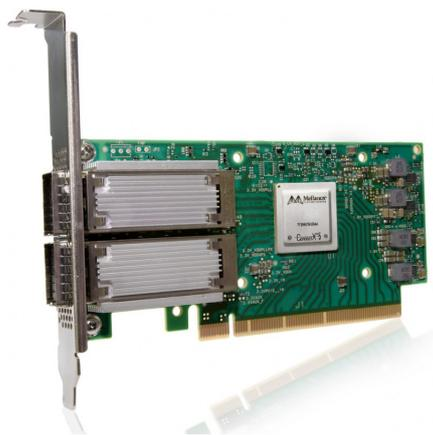
Carte adaptateur Mellanox MCX556A-EDAT ConnectX-5 Ex VPI, EDR IB (100 Gb/s) et 100 GbE, double port QSFP28, PCIe4.0 x16, support haut
