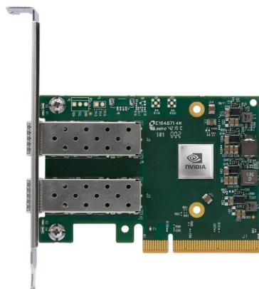
Mellanox MCX631102AN-ADAT ConnectX-6 Lx 25GbE Carte adaptateur Ethernet SFP28 PCIe 4.0 x8 HHL double port, support haut
