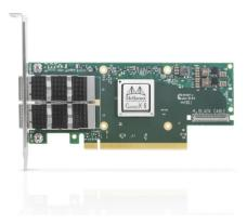
Carte adaptateur Mellanox MCX653106A-EFAT ConnectX-6 VPI, 100Gb/s (HDR100, EDR IB et 100GbE), double port QSFP56, PCIe3.0/4.0 Socket Direct 2x8 en ligne, support haut
