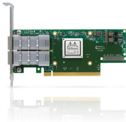
Carte adaptateur Mellanox MCX653106A-HDAT-SP ConnectX-6 VPI, HDR IB (200 Gb/s) et 200 GbE, double port QSFP56, PCIe4.0 x16, support haut, pack individuel
