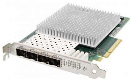
Véritable Qlogic QLE2694-SR-CK PCIe 3.0 x8 Quad-port 16GFC SR-Optic SFP+ Adaptateur Fibre Channel 16 Go pleine hauteur
