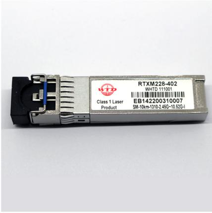
Module émetteur-récepteur SFP+ WTD 2.45G à 10.52G 1310nm 10Km
