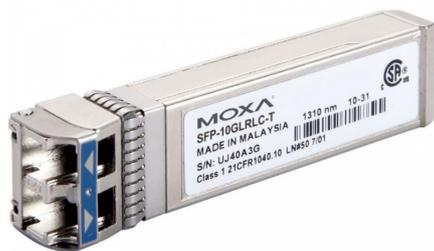
Module Moxa SFP-10GLRLC-T SFP+ avec 1 port 10GBase-LR, connecteur LC pour transmission 10 km, température de fonctionnement -40 à 85°C
