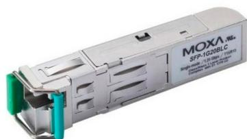
Module SFP Moxa SFP-1G20BLC de type WDM (BiDi) avec 1 port 1000BaseSFP avec connecteur LC pour une transmission de 20 km ; TX 1 550 nm, RX 1 310 nm, température de fonctionnement de 0 à 60°C
