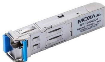
Module SFP Moxa SFP-1G40ALC-T de type WDM (BiDi) avec 1 port 1000BaseSFP avec connecteur LC pour une transmission de 40 km ; TX 1310 nm, RX 1550 nm, température de fonctionnement de -40 à 85°C
