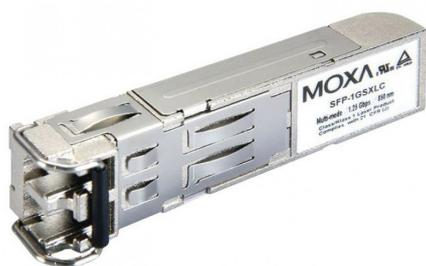
Module SFP Moxa SFP-1GSXLC avec 1 port 1000BaseSX avec connecteur LC pour transmission 300 m/550 m, température de fonctionnement 0 à 60°C
