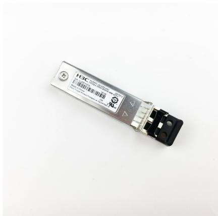
Émetteur-récepteur optique H3C 10G SFP+ SR (850 nm, 300 m, LC)
