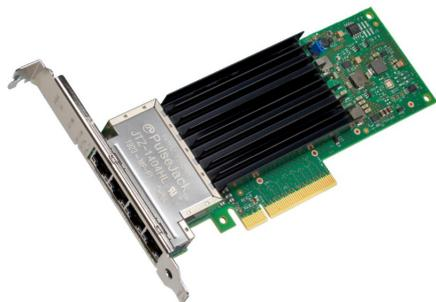
Carte réseau Ethernet Intel X710 10 GbE à quatre ports RJ45
