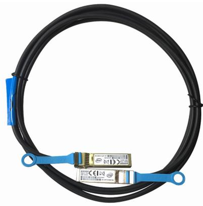
Câble cuivre Intel Ethernet SFP+ Twinax, câble passif à connexion directe de 3 m
